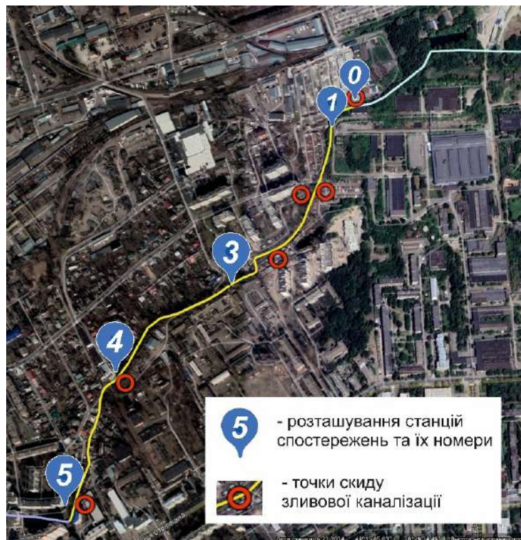
Рис.2.2. Схема розташування станцій спостережень і колекторів зливової каналізації.
